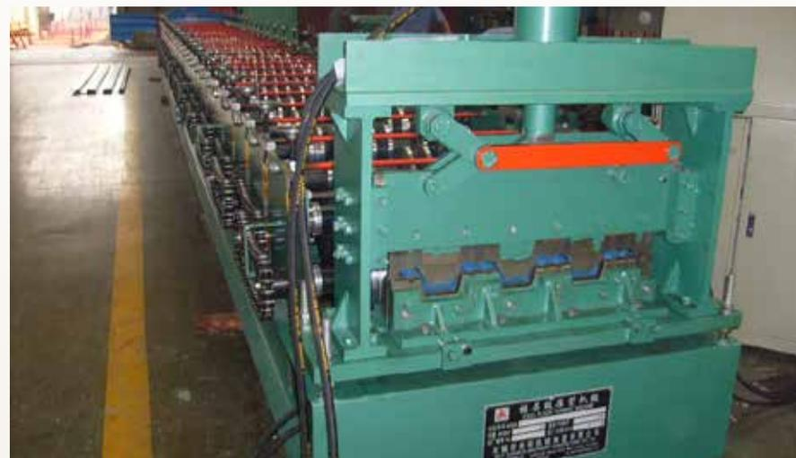
Fabriquée par une ligne de profilage à 26 rangs chaque toiture est étudiée au cas par cas. Les longueurs sont ensuite programmées. Lors de la fabrication des contrôles de qualité sont effectués tout au long du cycle de production. Les bacs ainsi appelés par les professionnels de la couverture sont livrés sur les chantiers.
